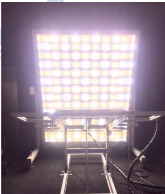
Rysunek 5.1 Symulator słońca klasy AAA firmy Eternal Sun
